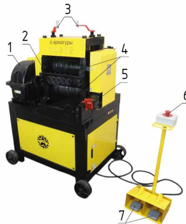
Рис. 2. Схема устройства станка для выпрямления арматуры VPK VPP-6/14: 1 – редуктор, 2 – направляющие втулки, 3 – регулировочные винты, 4 – выпрямляющие валы, 5 – узел резки, 6 – кнопка аварийного останова, 7 – педали управления.
