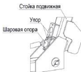
Рис. 5. Установка шаровой опоры
