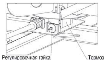
Рис. 4. Регулировка усилия тормоза
