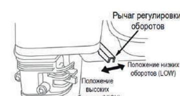
Рис. 6. Рычаг регулировки оборотов
