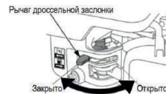
Рис. 7. Рычаг дроссельной заслонки
