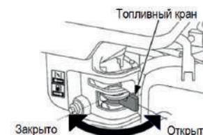
Рис. 5. Топливный кран
