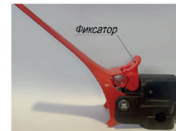
Рис. 5. Рабочее положение фиксатора ручки выключения электродвигателя
