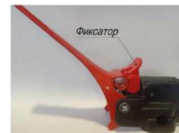
Рис. 5. Рабочее положение фиксатора ручки выключения электродвигателя
