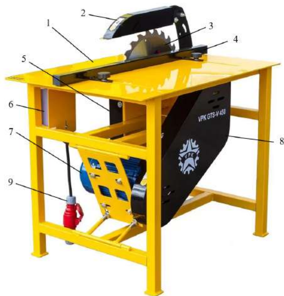
Рис. 1 – Схема устройства станка VPK GTS-V 450: 1 – рама станка, 2 – защитный кожух, 3 – пильный диск, 4 – упорная линейка, 5 – кожух диска, 6 – пускатель, 7 – электродвигатель, 8 – кожух приводных ремней, 9 – вилка с кабелем
