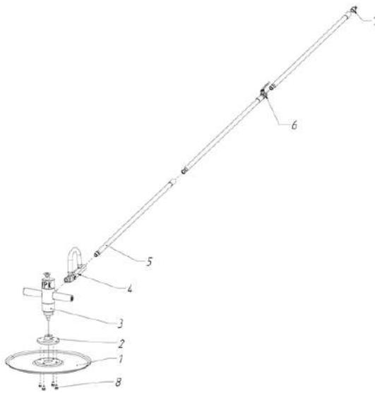
Рис. 2 – Схема сборки пневматической затирочной машины VPK ПЗМ – 450: 1 – затирочный диск, 2 – фланец, 3 – корпус, 4 – кардан, 5 – рукоять, 6 – кран, 7 – штуцер быстросъемный, 8 – комплектный крепеж.
