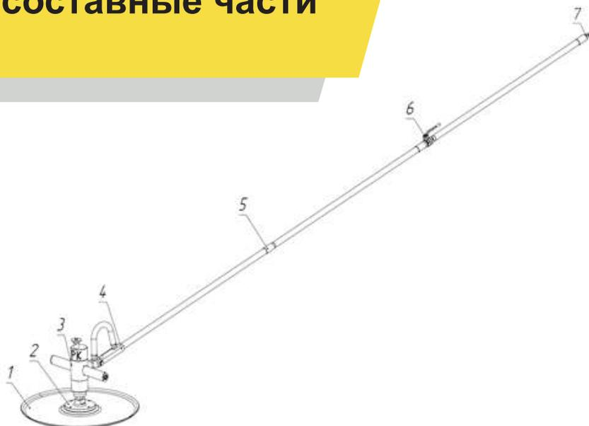
Рис. 1 – Схема устройства пневматической затирочной машины VPK ПЗМ – 450:
