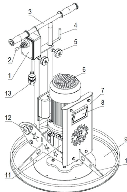
Рис. 1. Схема устройства затирочной машины VPK SKAT 600: 1 – коробка распределительная, 2 – переключатель-джойстик, 3 – рукоятка управления, 4 – крюки для укладки кабеля удлинителя, 5 – винты для регулировки высоты рукоятки, 6 – электродвигатель, 7 – щиток, 8 – прожектор, 9 – затирочный диск, 10 – рама, 11 – редуктор, 12 – винты для регулировки угла наклона рукоятки, 13 – вилка кабельная.
