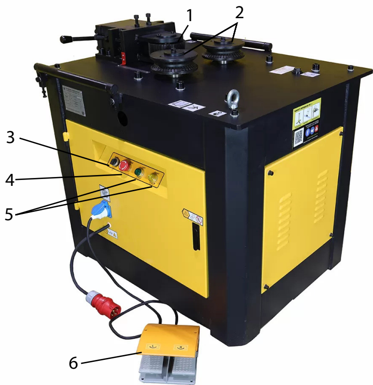
Рис. 1. Схема устройства станка для гибки спиралей и дуг VPK GS-36: 1 – прижимной ролик, 2 – ролики подачи сырья, 3 – двухпозиционный переключатель направления подачи сырья, 4 – кнопка остановки, 5 – кнопки подачи, 6 – ножная педаль управления
