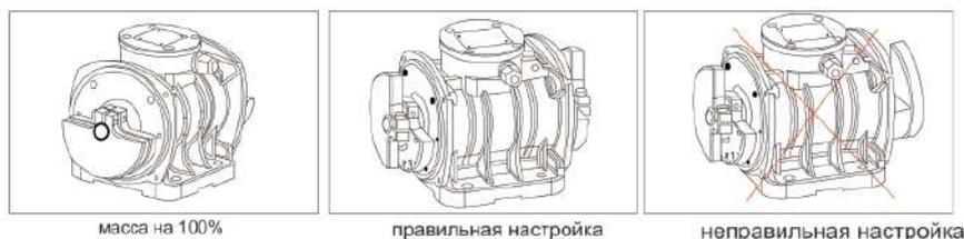
Рис. 11. Два дебаланса (эксцентрика) с каждой стороны
