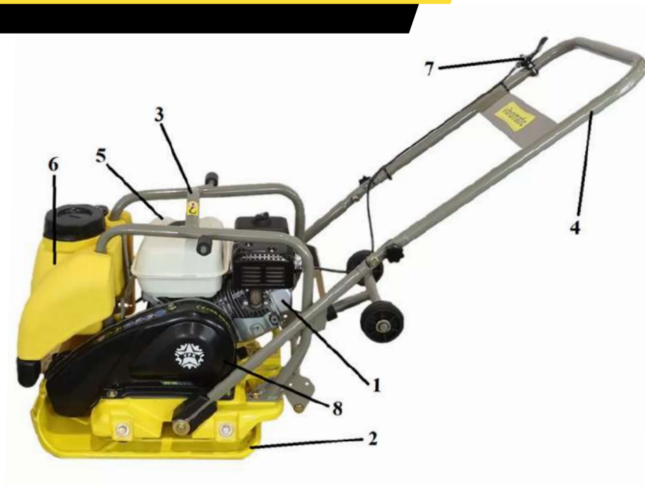
Рис. 3. Схема устройства виброплиты с поступательным движением HPF-90: 1 – двигатель, 2 – опорная плита, 3 – подъемная петля, 4 – ручка, 5 – топливный бак, 6 – бак для воды, 7 – рычаг регулировки оборотов на ручке, 8 – защитный кожух ременной передачи.
