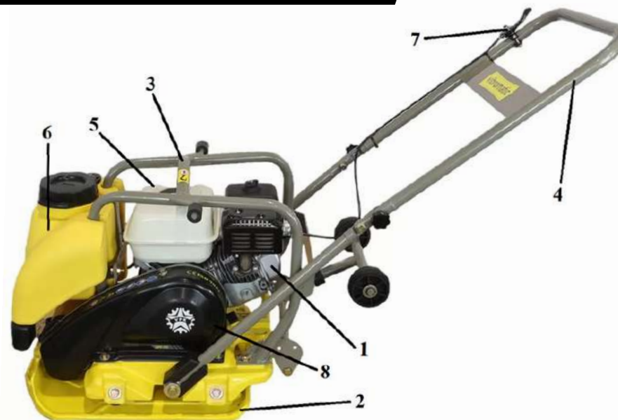
Рис. 3. Схема устройства виброплиты с поступательным движением HPF-90: 1 – двигатель, 2 – опорная плита, 3 – подъемная петля, 4 – ручка, 5 – топливный бак, 6 – бак для воды, 7 – рычаг регулировки оборотов на ручке, 8 – защитный кожух ременной передачи.
